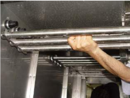
Makine üzerine, ön yıkama kollektörünün montajı
