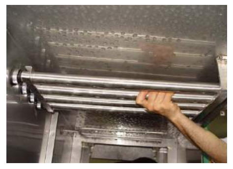
Makine üzerine, üst ana yıkama kollektörünün montajı
