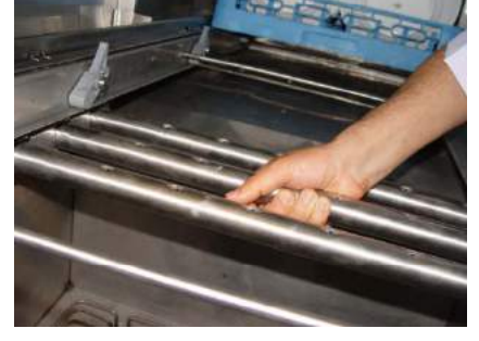
Makine üzerine, alt ana yıkama kollektörünün montajı
