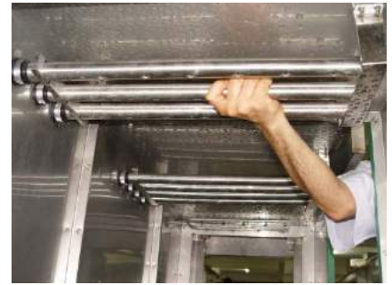
Makine üzerine, ön yıkama kollektörünün montajı
