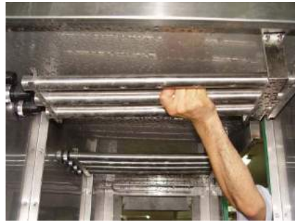
Makine üzerine, ön yıkama kollektörünün montajı
