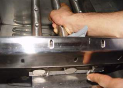
Makine üzerine, alt ana yıkama kollektörünün montajı
