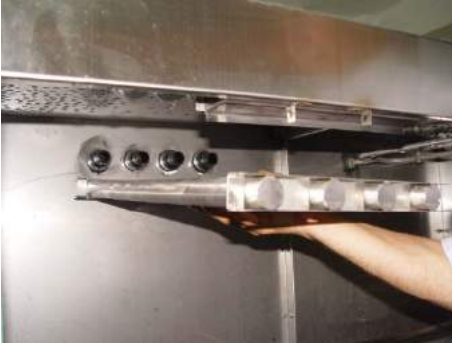
Makine üzerine, üst ana yıkama kollektörünün montajı
