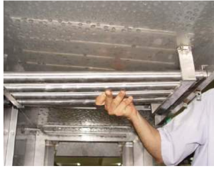
Makine üzerine, üst ana yıkama kollektörünün montajı
