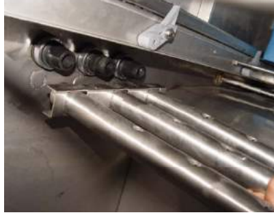
Makine üzerine, alt ana yıkama kollektörünün montajı
