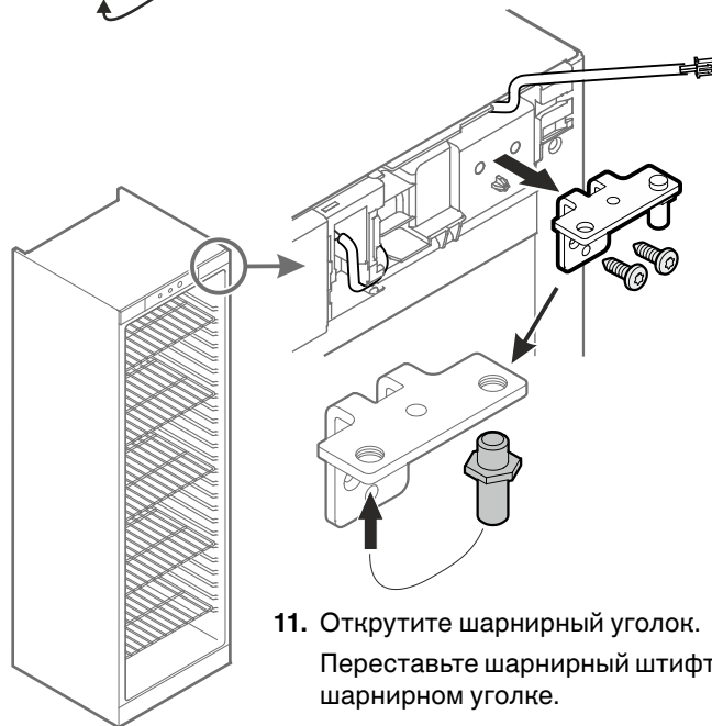
7. Удерживая шарнирный уголок, выкрутите правый винт.
