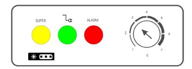
Термостат настраивается по шкале от 1 до 7, что равнозначно температуре от -15 до -25°C. Оптимальный настрой является при расположении стрелки на 3 или 4. Система охлаждения отключается при расположении стрелки на 0.
