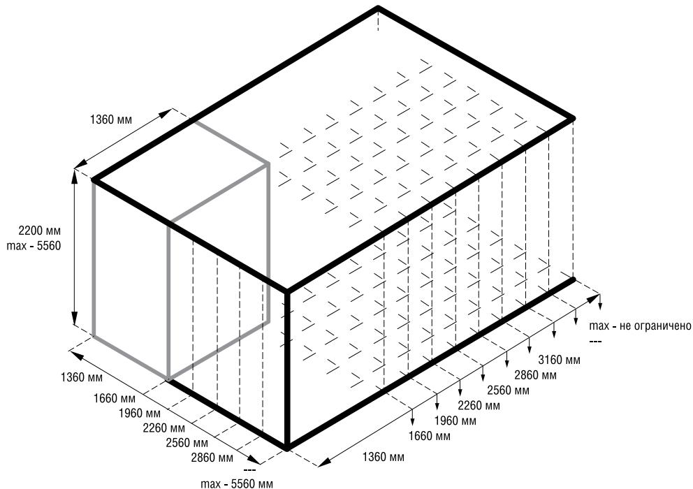
**Соответствие внутреннего объема (м<sup>3</sup>) и внешних размеров камер POLAIR Standard при высоте 2200 мм**
