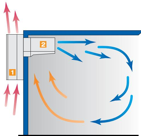
**Сплит-система** состоит из двух отдельных блоков, соединенных между собой медными трубами в теплоизоляции и кабелями питания и управления. Блоки сплит-системы можно размещать на некотором расстоянии друг от друга. Это позволяет использовать сплит-системы в случаях, когда толщина стен или размеры помещения, в котором находится холодильная камера, не позволяют установить моноблоки.
