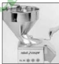
Установивте затем соответствующий диск ломтики и убедитесь, что он установлен правильно, поворачивая его в направлении часовой стрелки.
