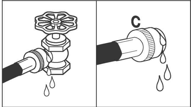
Для проверки на утечки откройте водопроводные краны. Небольшое количество воды может поступить в стиральную машину. Затем вода уйдет через слив.
