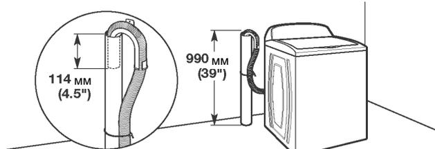
Минимальный диаметр слива стояка: 51 мм (2"). Минимальная скорость слива: 64 л (17 галлонов) в минуту. Высота верха стояка должна быть как минимум 990 мм (39"); уровень установки не должен превышать 1,22 м (48") относительно нижней части стиральной машины. Если высота установки больше 1,22 м (48"), то потребуется водоотливной насос.
