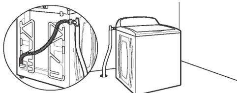
Для подключения к стоку в полу потребуются комплект сифонных затворов (шифр компонента 285834), 2 комплекта разъемов (шифр компонента 285835) и удлинитель для сливного шланга (шифр компонента 285863), который можно приобрести отдельно. Для заказа деталей обратитесь к дилеру, у которого вы приобрели стиральную машину, или в авторизованный сервисный центр. Минимальное расстояние для сифонного затвора: 710 мм (28") от нижней части стиральной машины. (Могут понадобиться дополнительные шланги.)
