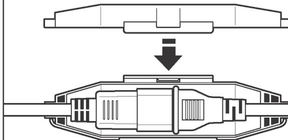
Закрепите сетевой шнур питания, уложив его в гнездо фиксатора шнура. Установите крышку для фиксации шнура и надавите на нее до щелчка. Убедитесь, что сетевой шнур питания сел в гнездо фиксатора и надежно зафиксирован в нем.
