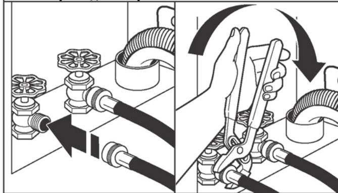
Подсоедините шланг к крану горячей воды. Вручную наверните муфту до ее плотной посадки на шайбе. С помощью плоскогубцев затяните муфты еще на 2-3 оборота. Повторите эту операцию со вторым шлангом для крана холодной воды.
