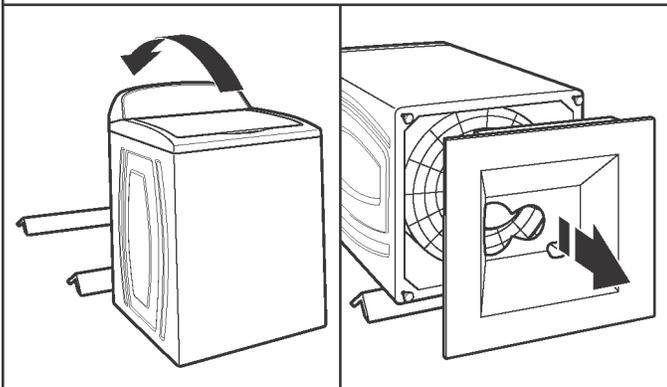
Чтобы не повредить пол, установите опоры, изготовленные из картонного поддона для транспортировки, на пол сзади стиральной машины. Сдвиньте стиральную машину назад и установите на картонные опоры. Снимите транспортное основание. Установите стиральную машину в вертикальное положение.
