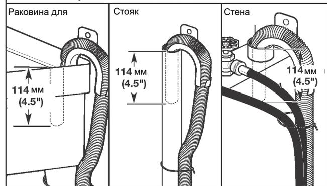
С помощью кабельной стяжки прикрепите сливной шланг к ножке раковины для стирки, сливному стояку или к впускным шлангам для настенного стояка.
