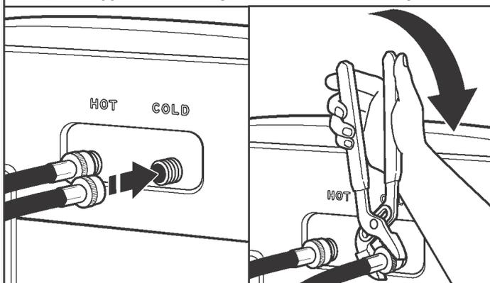
Подсоедините шланг горячей воды к впускному клапану горячей воды, обозначенному красным кольцом. Вручную наверните муфту до ее плотной посадки. С помощью плоскогубцев затяните муфты еще на 2-3 оборота. Повторите процедуру для впускного клапана холодной воды.
